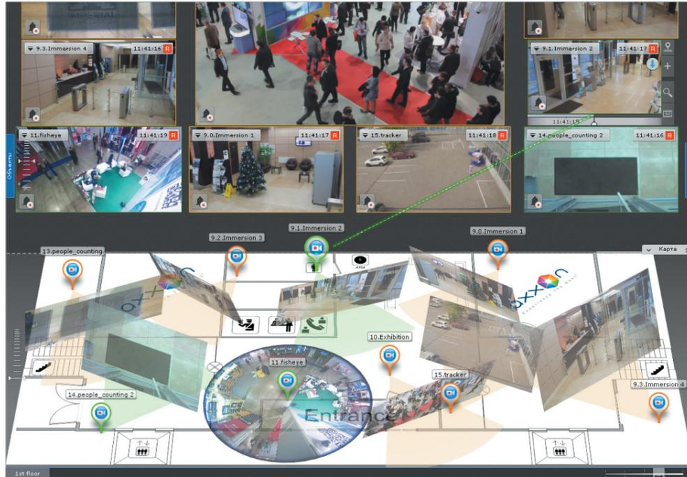
**Интерактивная 3D-карта** представляет собой обычный растровый план объекта, расположенный на экране под окнами видео в перспективной проекции. На карте можно указать места расположения камер, отображаемых в раскладке, а также значки датчиков и реле. Кликнув по окну видео, вы сразу увидите, где соответствующая камера расположена на карте.
