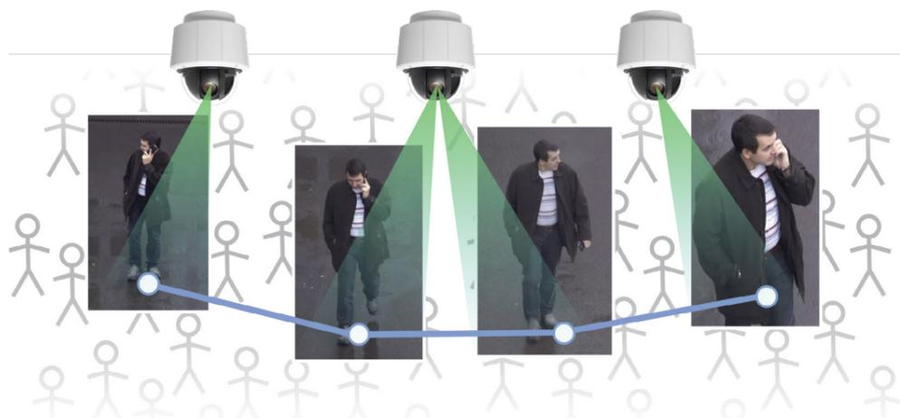
**Функция Tag&Track Pro позволяет одновременно получать полную картину наблюдаемой территории и детализированные изображения движущихся на ней объектов,** обеспечивая их обнаружение и сопровождение. При этом оба изображения могут записываться в архив, что важно для расследования различных происшествий.
