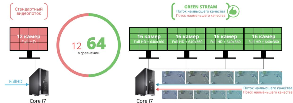
**Функция GreenStream автоматически выбирает видеопоток, поступающий от камеры на сервер, а затем на клиент, в зависимости от того, в каком разрешении видео отображается на клиенте в данный момент.**
